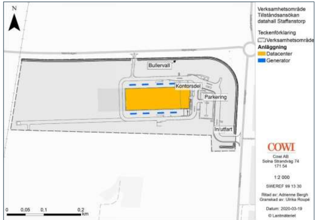
Figur 3. Den planerade verksamheten med en datahall där tillståndspliktiga generatorer installeras intill byggnaden. Den mindre generatoren för kontorsdelen placeras intill en generator som är kopplad till datahallen.
